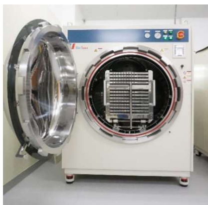
TBR-901カスタム仕様(15段ラック) TBR-901 custom (15 shelf rack)
