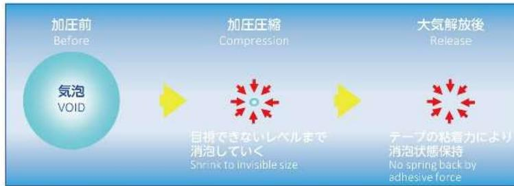
フィルムの加圧脱泡テスト Void elimination in film by air compression
