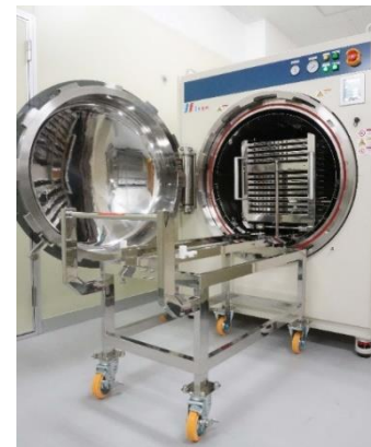
ラックをチャンバーへスライド投入 Slide the rack into the chamber
