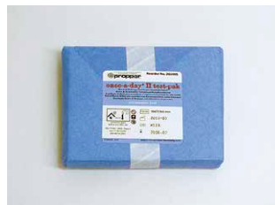
空気排除・蒸気浸透性確認用 ケミカルインジケータ
