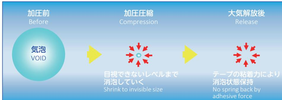
フィルムの加圧脱泡テスト Void elimination in film by air compression
